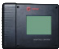
Интерфейс DynaView контроллера Tracer™ CH.530
